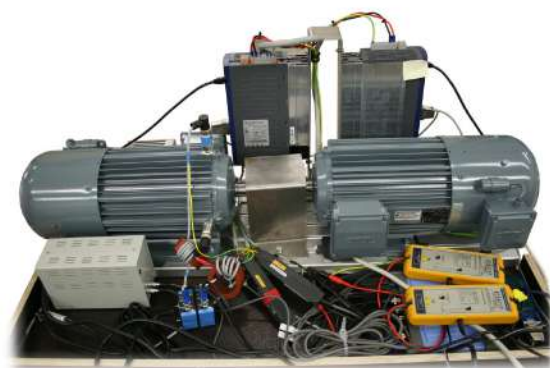
Fig. 1 Test bench (model: EMOD FKIE2100LA, P mech : 3 kW, n nom : 1440 /min, V nom : 400V, I nom : 6.4A, cosφ: 0.78)
